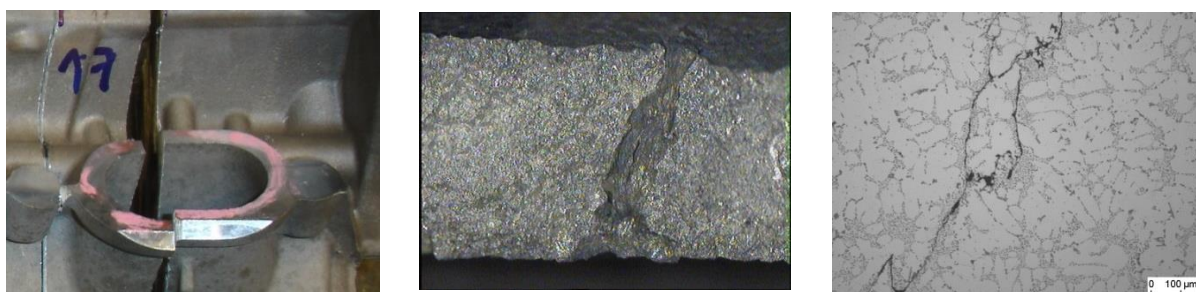
(a) 切割泄漏的汽缸盖
