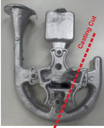
▲ 图14(a): 重力金属型铸造产生的“夹具底座”
