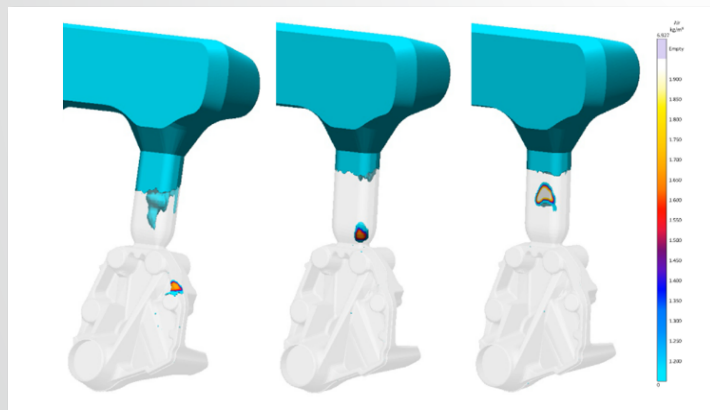
流动前沿的精确描述展示了浇注系统中的卷气
