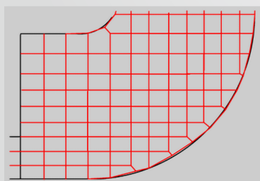
TAG网格用于准确表示铸件的几何形状
