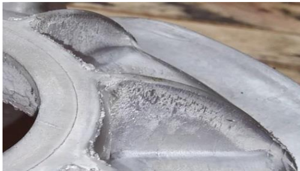
图 3e: (左上和左下) 由于模具表面的气蚀导致铸件表面多料；
