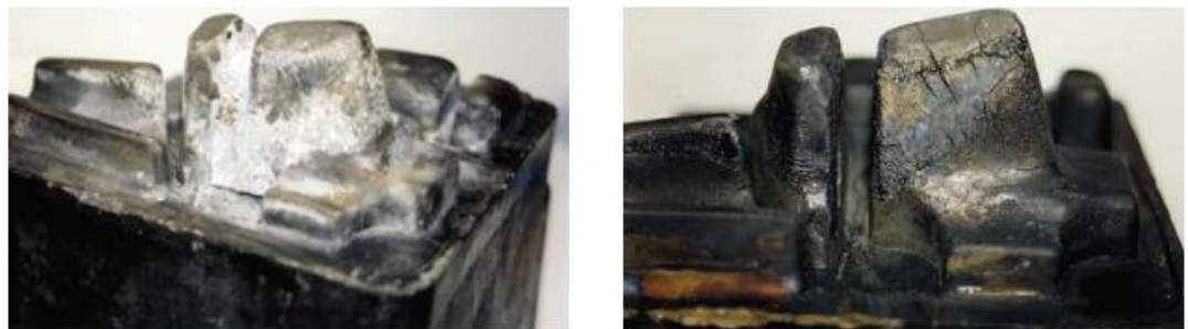
图 5b: (左) 模具上的粘模效应; (右) 粘模产生后对模具的损坏
