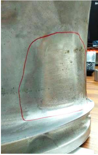
图 3c: 船用发动机变速箱冲蚀
