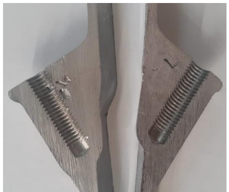
图 4e: A-A 的横截面视图。图片显示加工区域的缩孔
