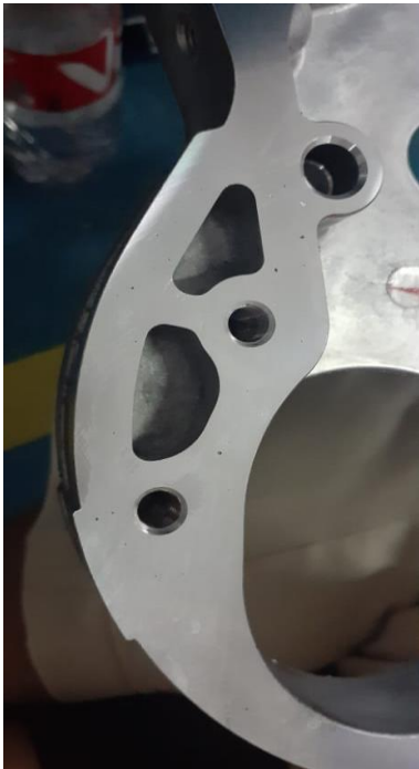
图 2e: 缩孔和气孔如上图所示。从模拟中可以清楚地看出缺陷与气孔的关系更大。
