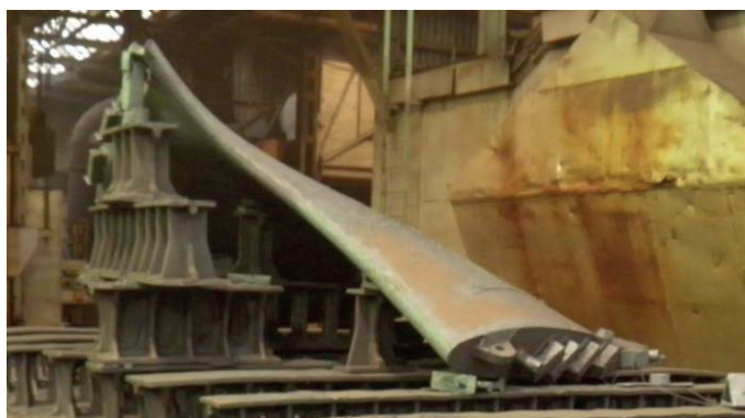
整个工艺过程结束后，与原始形状(左)相比，使用模具中的预补偿减少了变形
