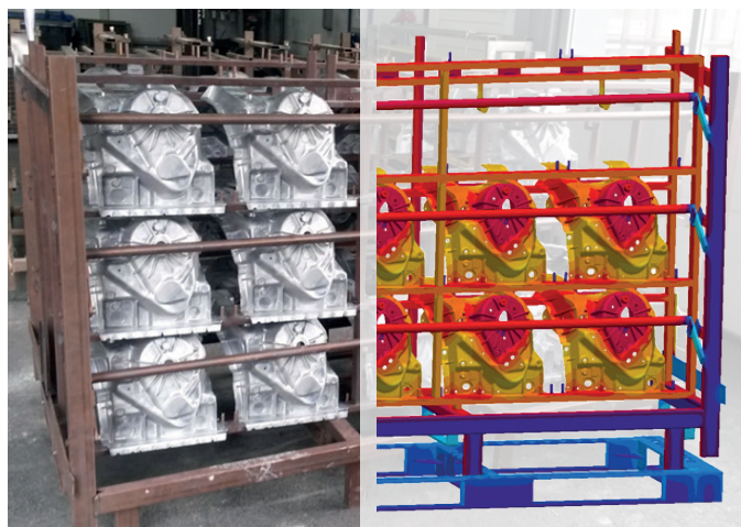
模拟放置在热处理支架上的铸件的真实工艺
