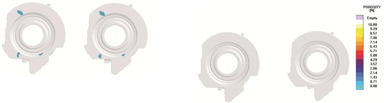
图 5：重新设计铸件和修改灰铸铁铸件浇注系统技术使得大幅降低能耗和成本【14】。
